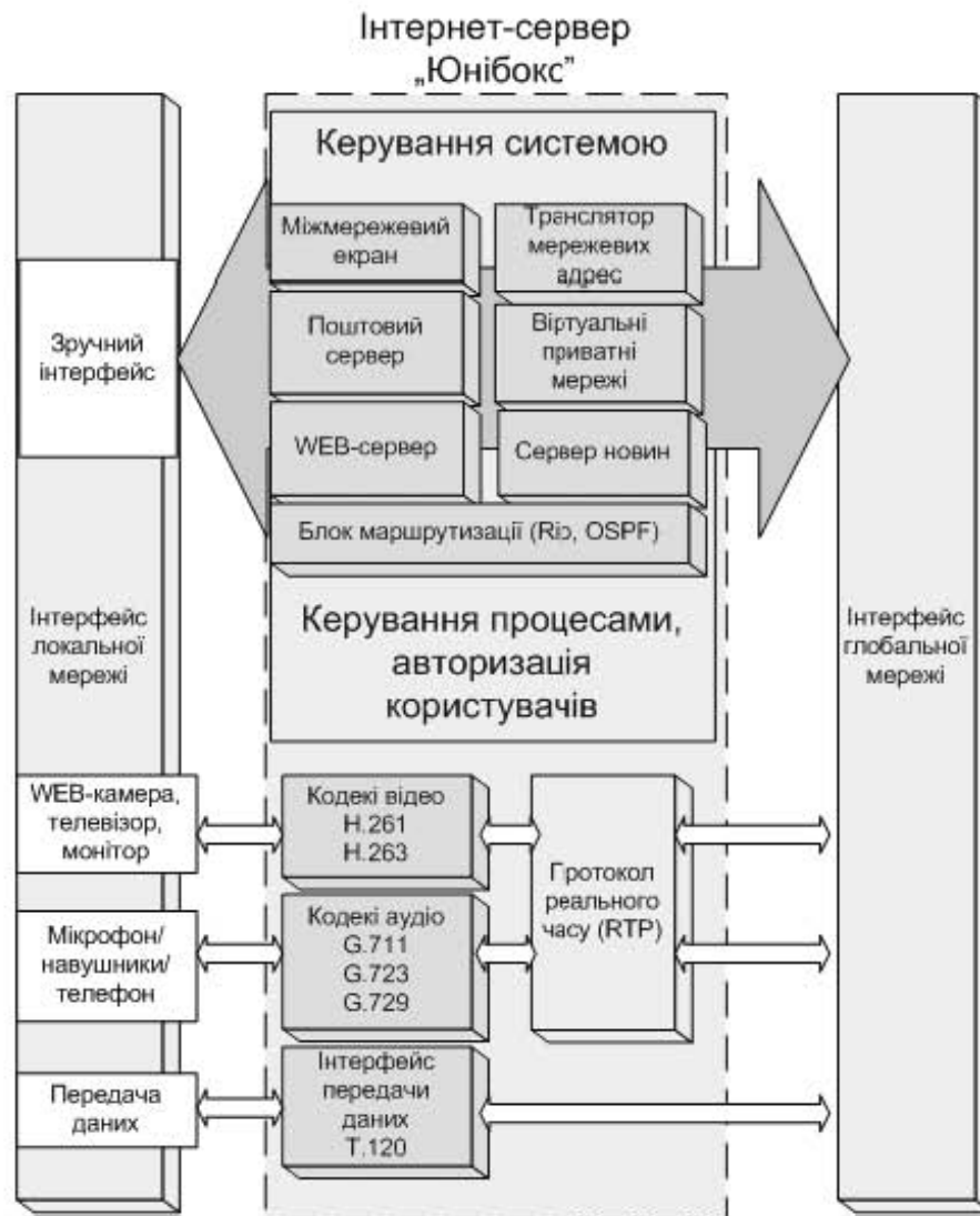
Рис. 3. Функціональна блок-схема інтернет-сервера „Юнібокс”
