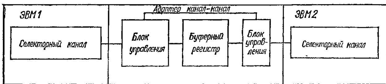
Рис. 24. Сопряжение ЭВМ через адаптер
